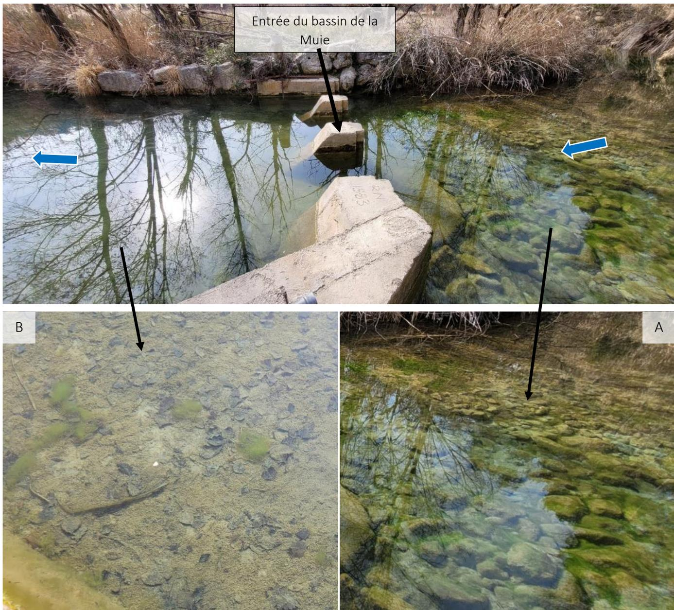
Illustration 64 : Différence granulométrique des matériaux stockés en amont (A), et dans la retenue de la Muie (B)
